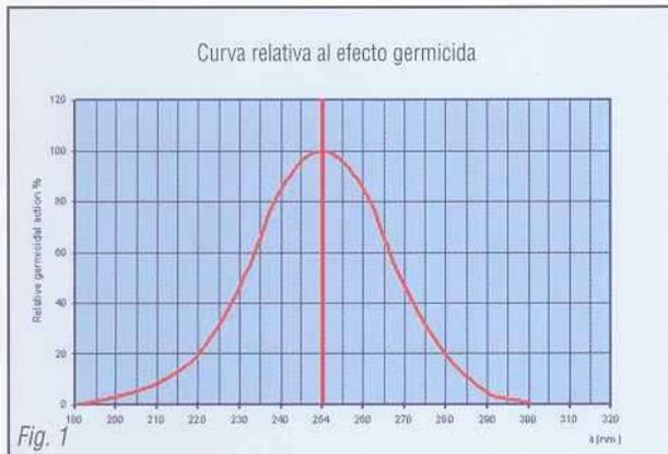
La radiación fundamental UV-C con el máximo de efecto germicida se representa por la línea espectral de 253,7 nm (punto en el cual los ácidos nucleicos de los microorganismos tienen su mayor absorción). A partir de la Fig. 1 se puede apreciar que la acción germicida llega a ser máxima cuando la radiación alcanza la longitud de onda de 253,7 nm. La rapidez de variación de cada vertiente de la curva indica que el efecto germicida desciende rápidamente en cuanto la radiación se aleja de su máximo.
